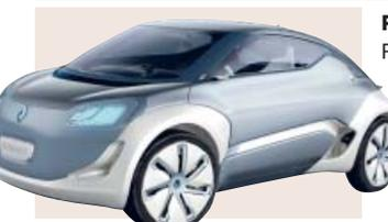
**RENAULT ZOE, listo en 10 minutos.** La gran apuesta de Renault para un coche con apariencia de coche y propulsión únicamente eléctrica. Alcanza los 135 km/hora, se recarga por completo en unas siete horas en un enchufe doméstico, pero tiene la opción de poder recargarse en diez minutos para obtener 50 kilómetros de autonomía. A partir de 14.700 euros.
