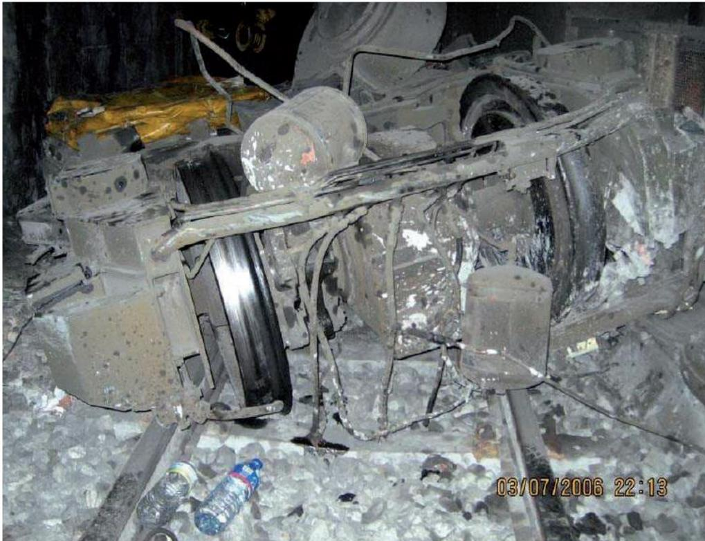
Sin embargo, tal y como muestra el informe sobre el estado de los mismos al llegar al taller, la cabeza de acero se secciona, literalmente, y se separa totalmente el bogie del chasis del tren.
