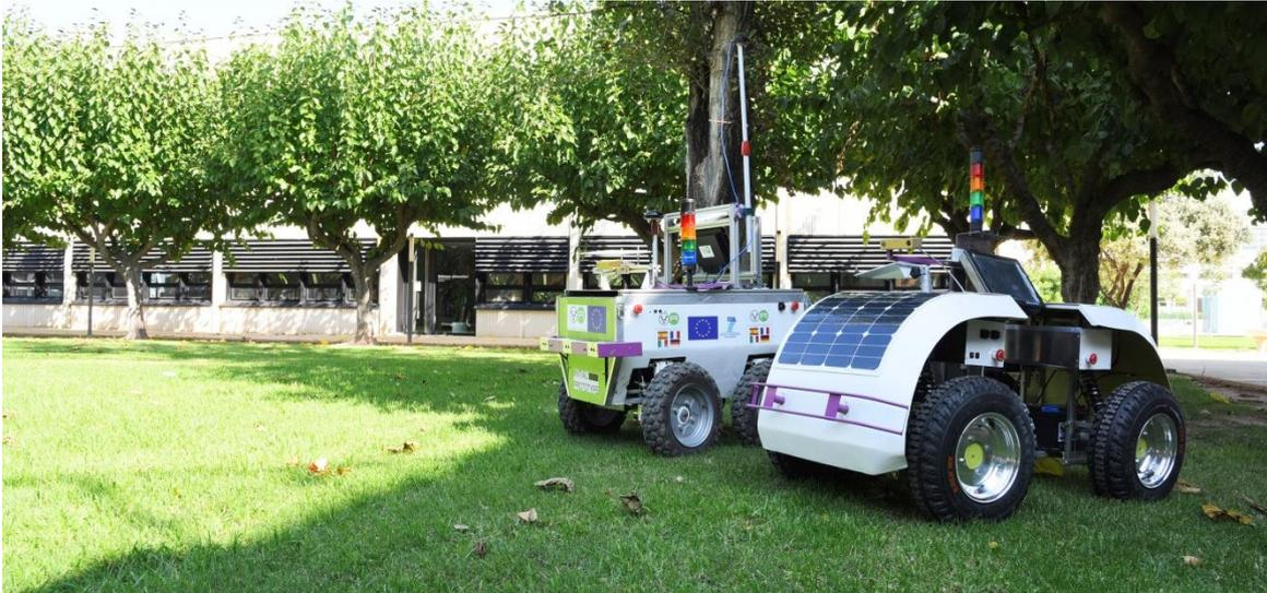
El laboratorio de Robótica Agrícola de la UPV presenta dos prototipos de robot autónomo para realizar mapas agronómicos sobre viñedos. Se trata de vehículos eléctricos de cuatro ruedas, con un peso en torno a 100 kg, una altura de 1.5 m y una planta de aproximadamente 1m x 1,5m, que incorporan sensores de ultrasonidos, paneles solares, un sensor de monitorización y un sistema de visión artificial, que ayuda a decidir cuándo vendimiar.
