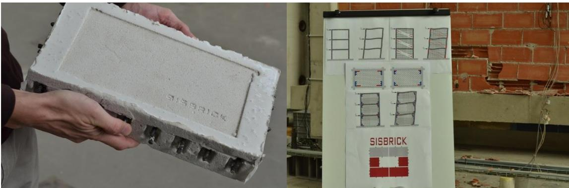
Sisbrick es un nuevo dispositivo -con forma de ladrillo- que permite mejorar la respuesta de los edificios ante movimientos sísmicos, desarrollado por investigadores del Instituto de Ciencia y Tecnología del Hormigón (ICITECH) y patentado por la UPV.
