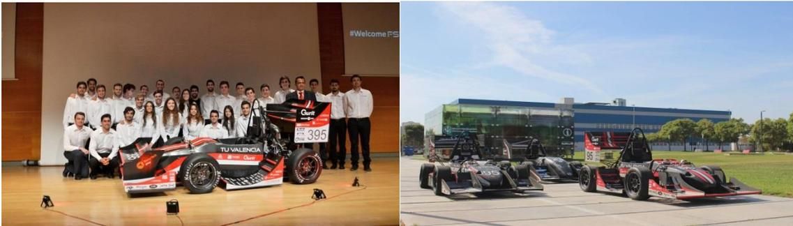
Este prototipo es capaz de acelerar de cero a cien en 3.8 segundos, tiene un peso de unos 225Kg y es uno de los más competitivos a nivel mundial. Creado con los mejores materiales y procesos de fabricación, entre sus innovaciones destaca su monocasco en fibra de carbono con núcleo de nido de abeja de aluminio, el paquete aerodinámico para optimizar el tiempo por vuelta así como su sistema de telemetría.
