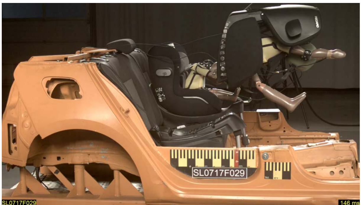
Ilustración 3: Recaro Optia y Base Smart Click en choque frontal
