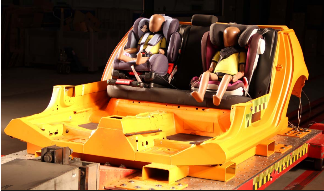
Ilustración 4: Diseño de la prueba para el test de impacto frontal
