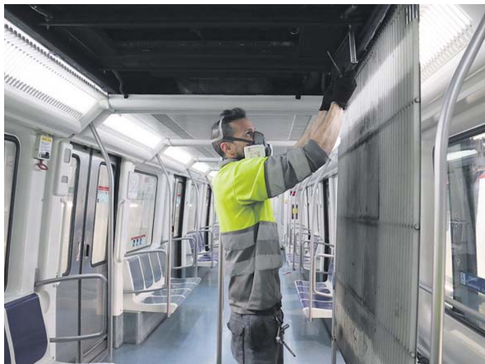
Un operari extreu els filtres d'aire d'un tren per determinar si hi ha amiant. MAR VILA / ACP
