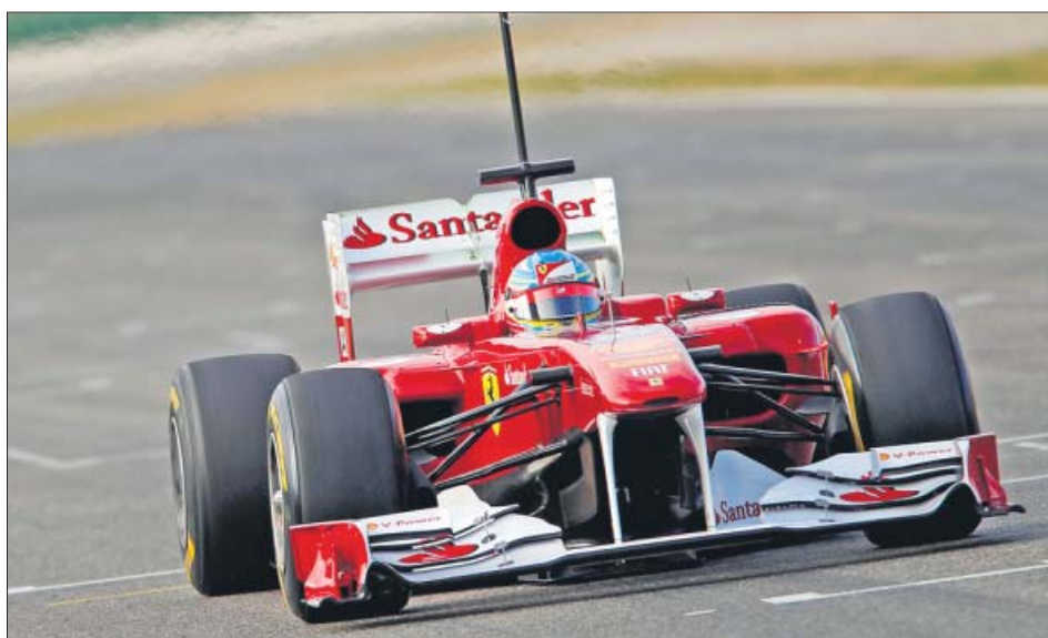
El F150 de Fernando Alonso rodó en Cheste con una enorme antena para recoger datos.
