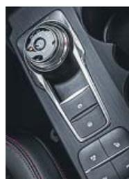
↑ Detalle del mando giratorio que controla el cambio automático.
