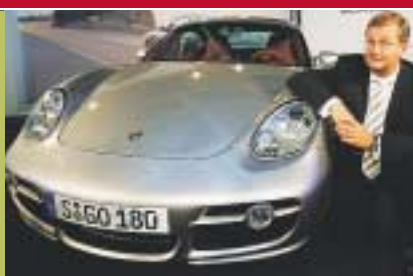
Porsche Cayman S → Coupé biplaza y monocasco, de motor central (alcanza 295 CV) y tracción trasera.
