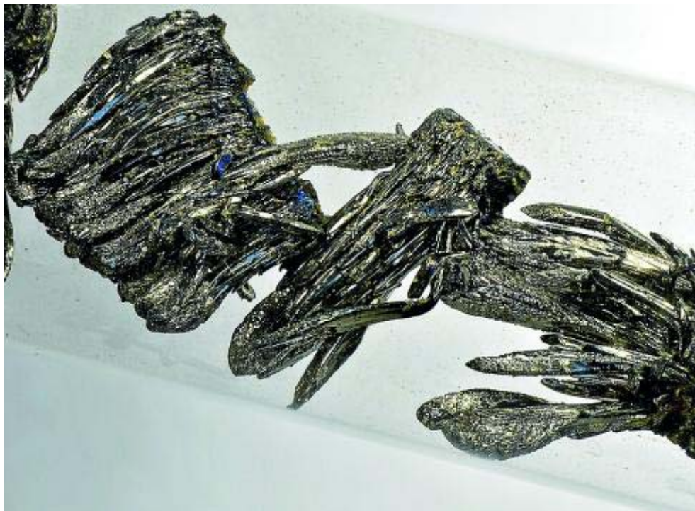
El europio forma compuestos fluorescentes usados en dispositivos como televisiones en color, lámparas fluorescentes y cristales.
