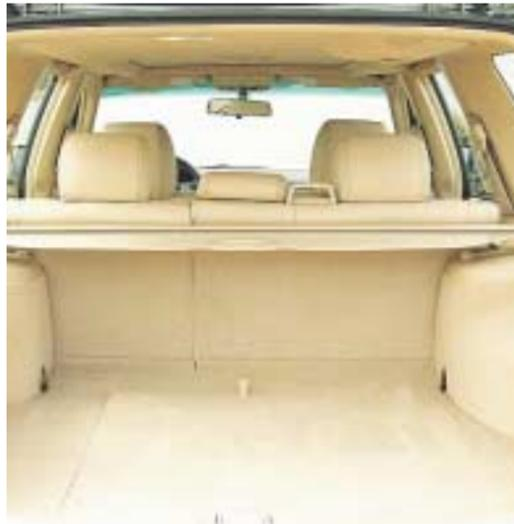
El maletero tiene una capacidad de 387 litros debido a su limitada altura.
