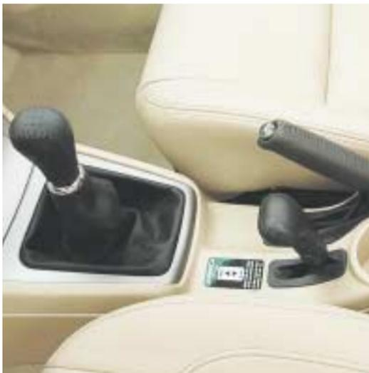
Esta pequeña palanca, situada junto al freno de mano, sirve para insertar la reductora.
