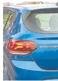
↑ Las ópticas LED tienen forma de 'Y' en posición horizontal.
