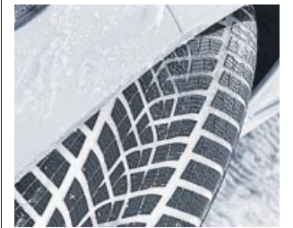
Estos neumáticos funcionan mejor por debajo de 7 grados.
